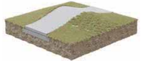
Sur une fondation en béton, au niveau du sol. Colocado en una base de hormigón al nivel del suelo.
